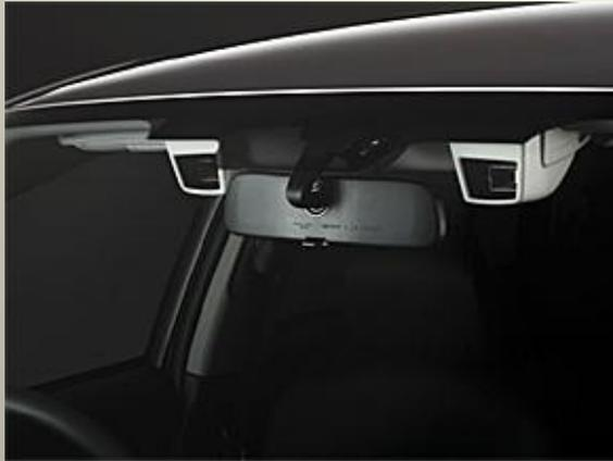
ステレオカメラにより対象の接近を感知し、自動的にブレーキをかけるスバルのアイサイト
